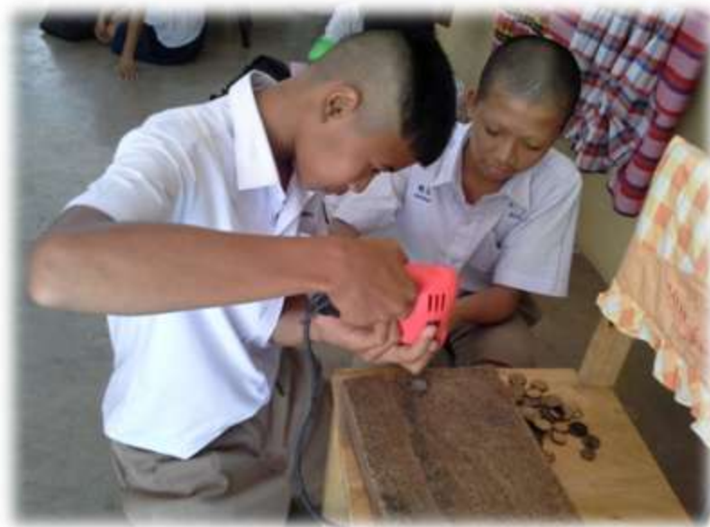
ภาพที่ 65 เจาะรูทะลุรอบวงตามจุดที่กำหนด ที่มา : จุรีลักษณ์ อินสุยะ, 2559.
