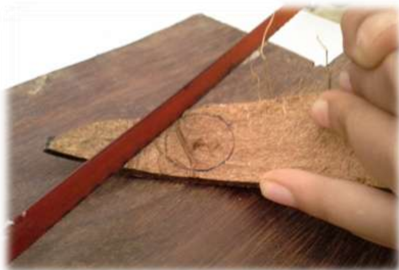
ภาพที่ 27 ใช้เลื่อยตัดลงบนชิ้นกะลาตามรอยที่วาดแบบ ที่มา : จุรีลักษณ์ อินสุยะ, 2559.
