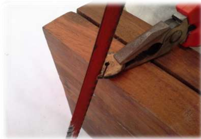
ภาพที่ 35 เลื่อยตามรอยวาดเพื่อทำตัวล็อกกันหลุด ที่มา : จุรีลักษณ์ อินสุยะ, 2559.
