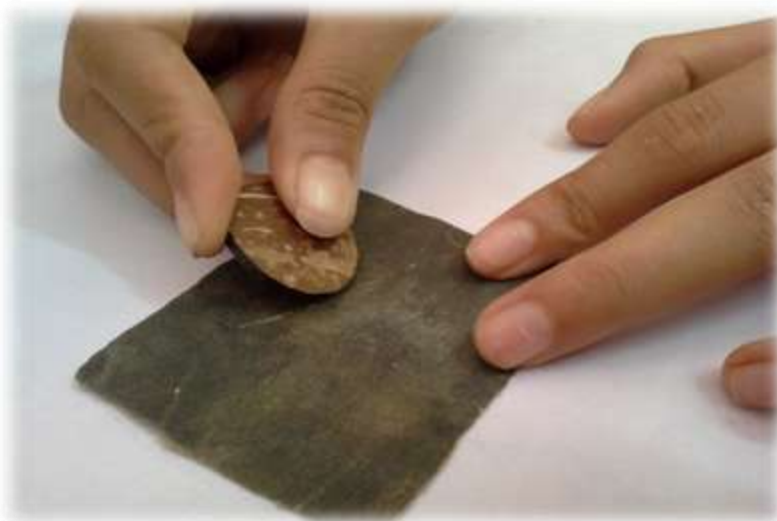
ภาพที่ 29 ขัดชิ้นกะลาที่เลื่อยให้เรียบเนียนและบาง ที่มา : จุรีลักษณ์ อินสุยะ, 2559.
