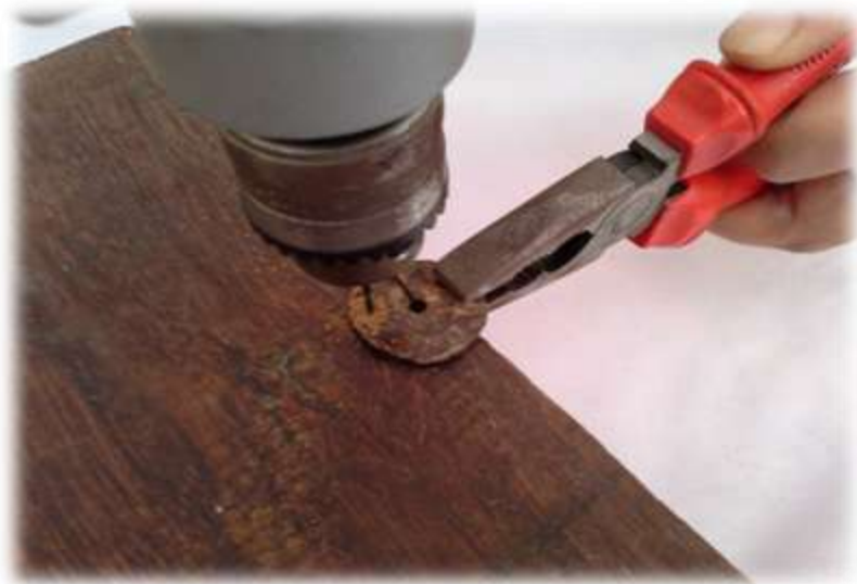
ภาพที่ 36 การเจาะรูตามรอยวาดเพื่อทำตัวล็อคกันหลุด ที่มา : จุรีลักษณ์ อินสุยะ, 2559.
