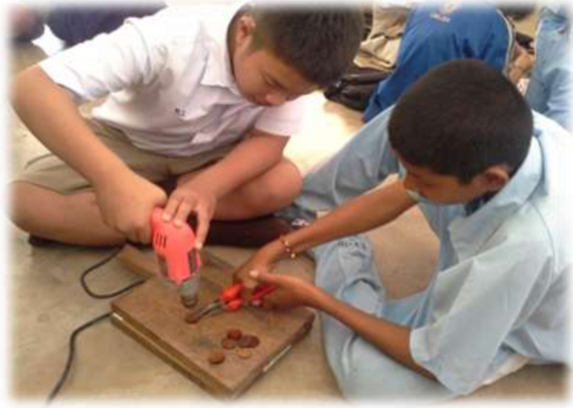
ภาพที่ 64 ทำการเจาะรูทะลุในส่วนตัวกันหลุด ที่มา : จุรีลักษณ์ อินสุยะ, 2559.
