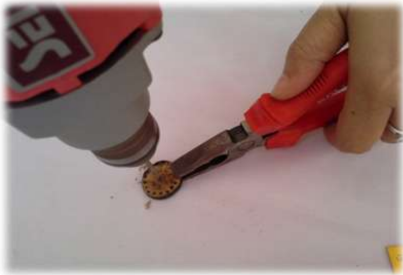
ภาพที่ 32 ใช้ส่วนไฟฟ้าเจาะกะลาโดยวางรูที่เจาะให้ตรงกลาง ที่มา : จุรีลักษณ์ อินสุยะ, 2559.
